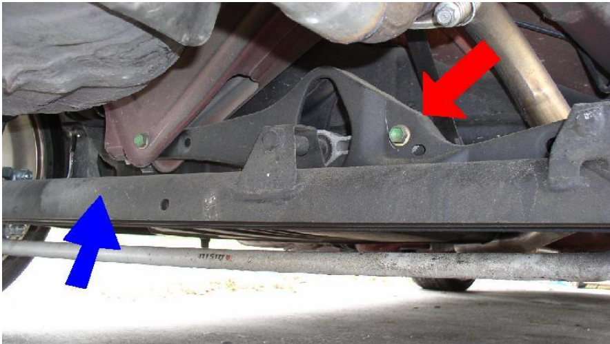
Un mecanismo de Scott Russell en el eje trasero de un Nissan Sentra del año 2002. Fuente: Wikimedia Commons, con licencia Creative Commons
